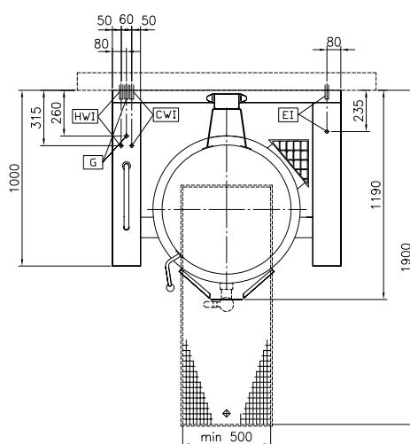
Pentola a gas basculante 150 lt. (h), carico automatico acqua calda/fredda con rubinetto, doccetta, kit di chiusura posteriore.
